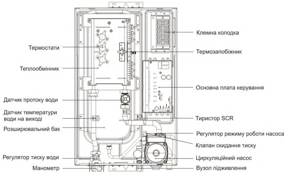
Мал. 2. Схема внутрішньої конструкції виробу
